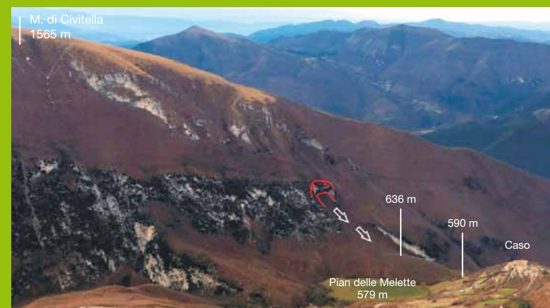
Panoramica del Pian delle Melette, del M. di Civitella e del paese di Caso dalla cresta del M. Coscerno (In rosso è evidenziata la nicchia di distacco e la superficie di scivolamento; la freccia bianca indica il senso di movimento; sono indicate le quote del M. di Civitella - 1565 m, del Pian delle Melette - 579 m, del rilievo formato dal corpo di frana - 636 m e della soglia che divide il Pian delle Melette e la media Valcasana dalla bassa Valcasana - 590 m).
